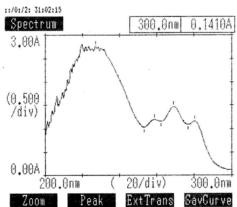
Questo è lo spettro dello stesso olio precedente, sottoposto però a cottura. Si nota che le caratteristiche precedenti non sono state perse e quindi l'olio, anche dopo l'utilizzo, mantiene le caratteristiche di resistenza alle alte temperature per cui è stato progettato.
