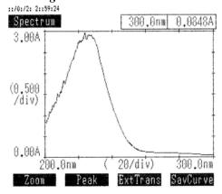
Questo spettro di assorbimento indica l'assoluta perfezione dell'olio in analisi che non ha subito deterioramento o sofisticazione artificiale. E' caratteristica la curva dai 260nm ai 230nm: se priva di "scalini" indica un olio completamente puro di prima qualità.
